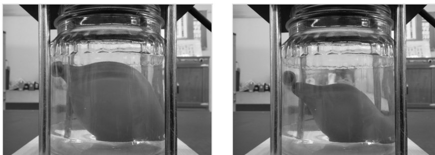
加圧前 加圧後 図11 圧力容器内に入れて加圧前後の風船の様子
