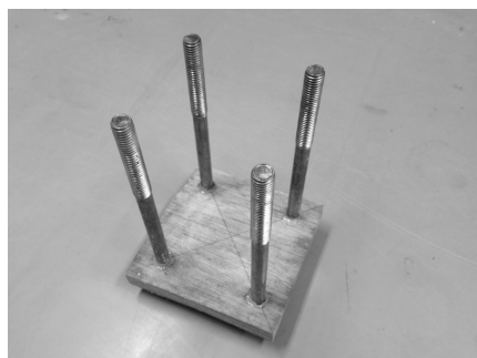
図5 金属棒を取り付けた下板表面
